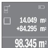
Нажмите на кнопку измерения 4, чтобы произвести еще одно измерение площади. Определите площадь в соответствии с разделом «Измерение площади», см. стр. 61. Чтобы завершить сложение, нажмите на кнопку измерения 4. Чтобы прибавлять другие измеренные значения, еще раз нажмите на кнопку 7 [+] и т.д.
