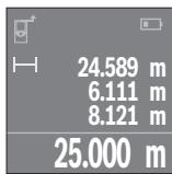
Нажмите на кнопку измерения **4** один раз для наводки на цель и еще раз для измерения.
