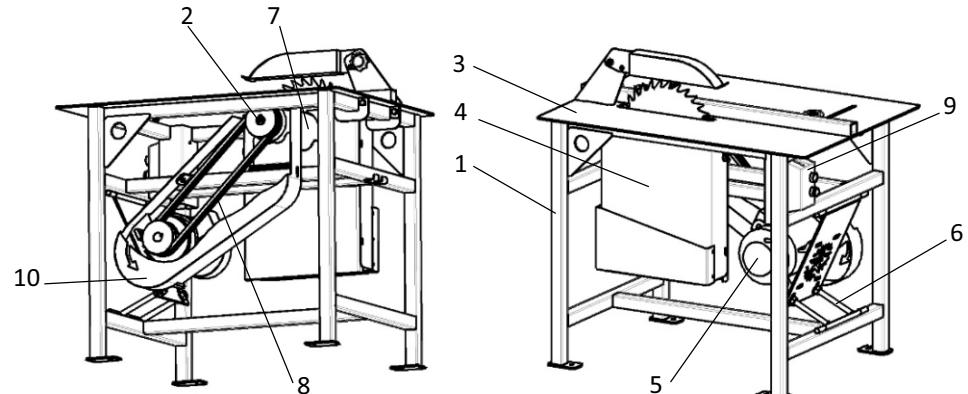
Вращение от двигателя на пильный вал передается клиноременной передачей (поз. 8).
