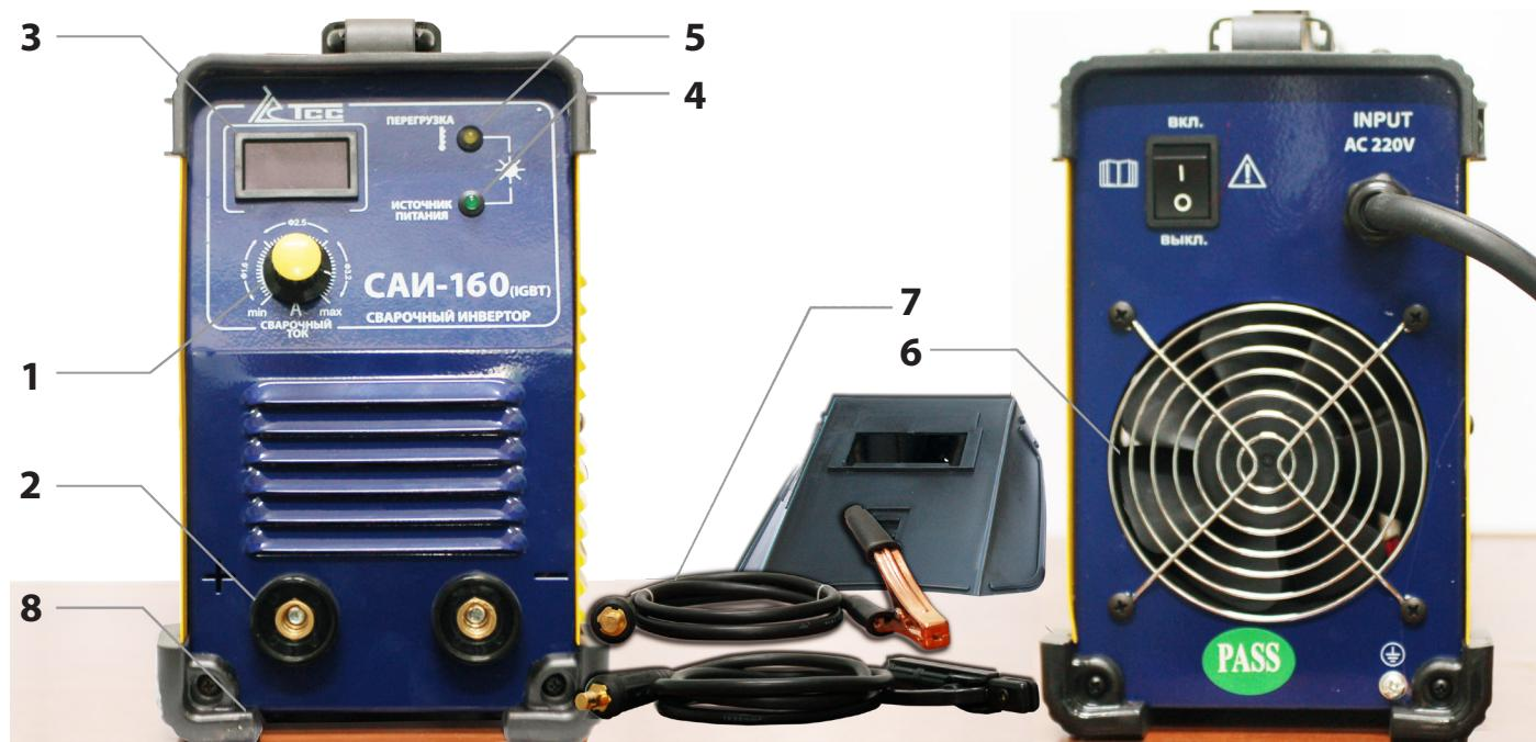
1 - регулировка сварочного тока; 2 - выводы для подключения кабеля; 3 - цифровой дисплей; 4 - индикатор сети;
